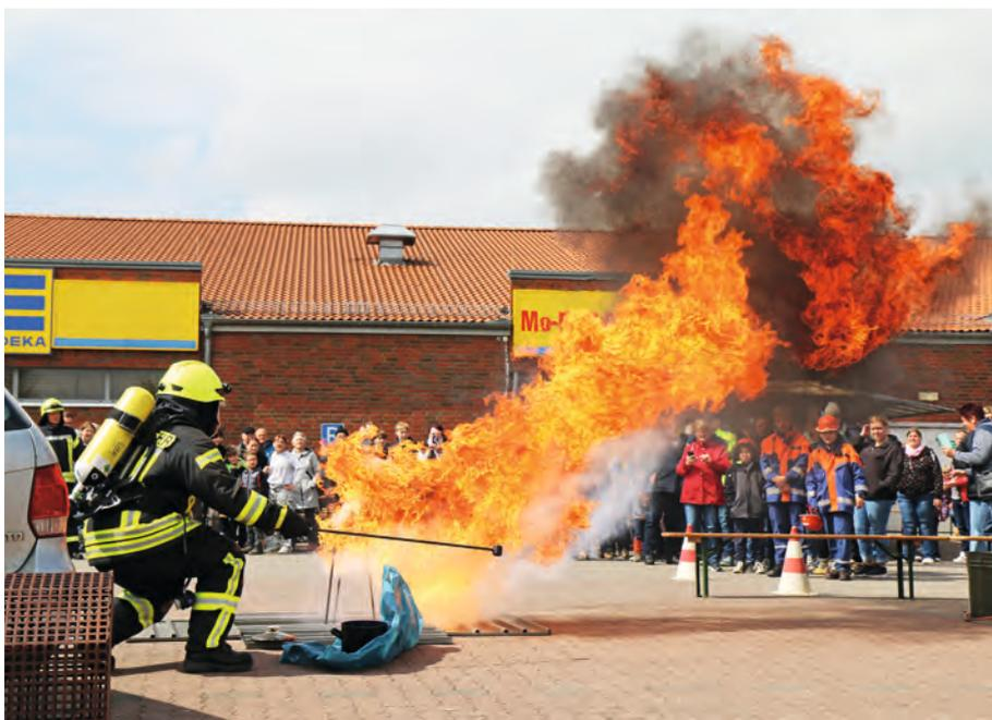
Foto (Jasper Hentschel): So sieht die Wirkung aus, wenn Fettbrand mit Wasser gelöscht wird
