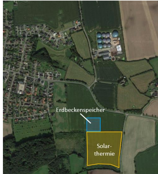
Abb. 50: Größenabschätzung einer solarthermischen Wärmeerzeugungsanlage
