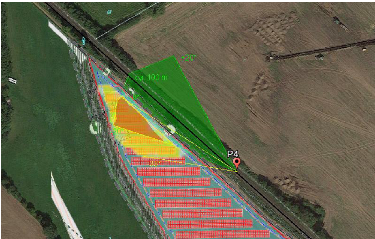
Bild 4.5.1: Simulation am Messpunkt P4 (Quelle: Google Earth / SolPEG)
