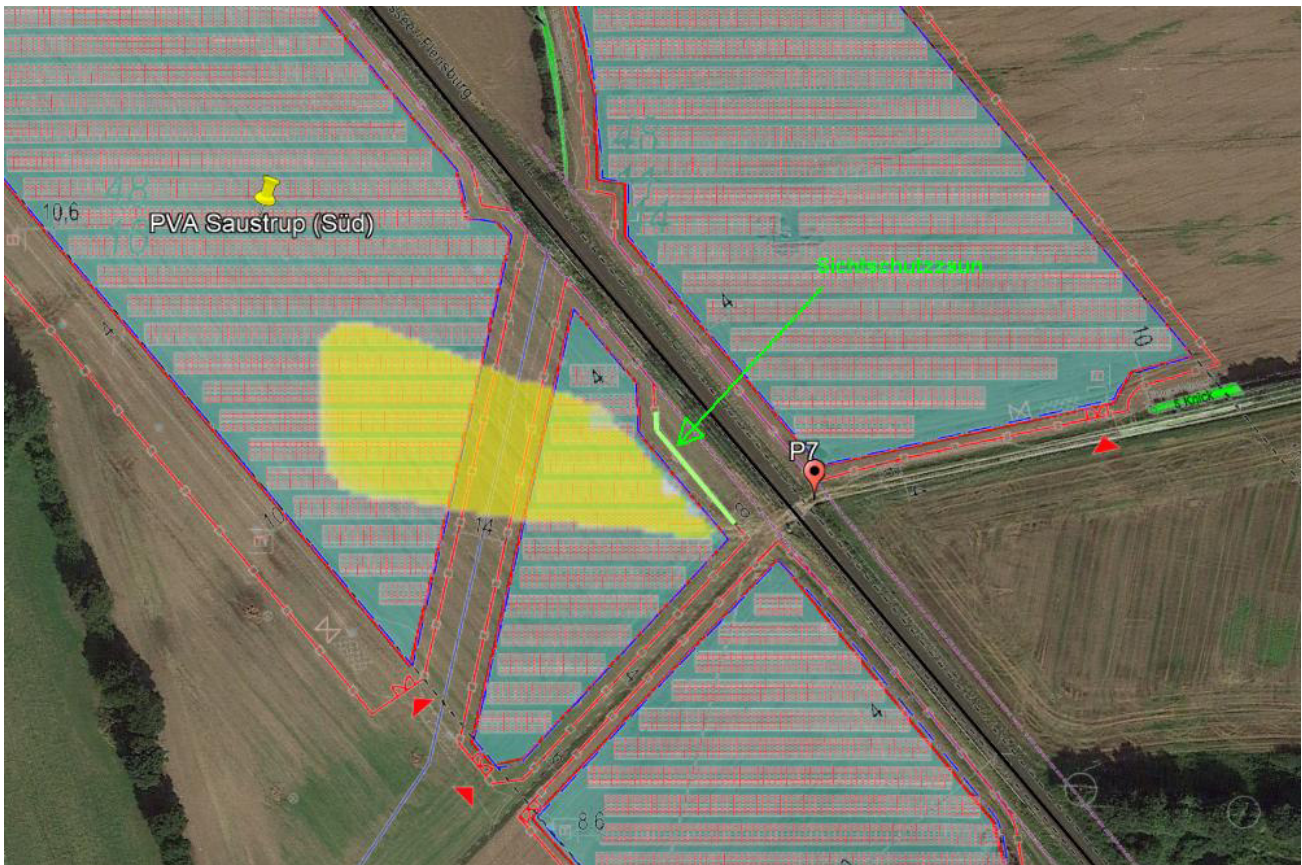
Bild 4.8.3: Empfohlene Sichtschutzmaßnahme im Bereich Messpunkt P7 (Quelle: Google Earth / SolPEG)
