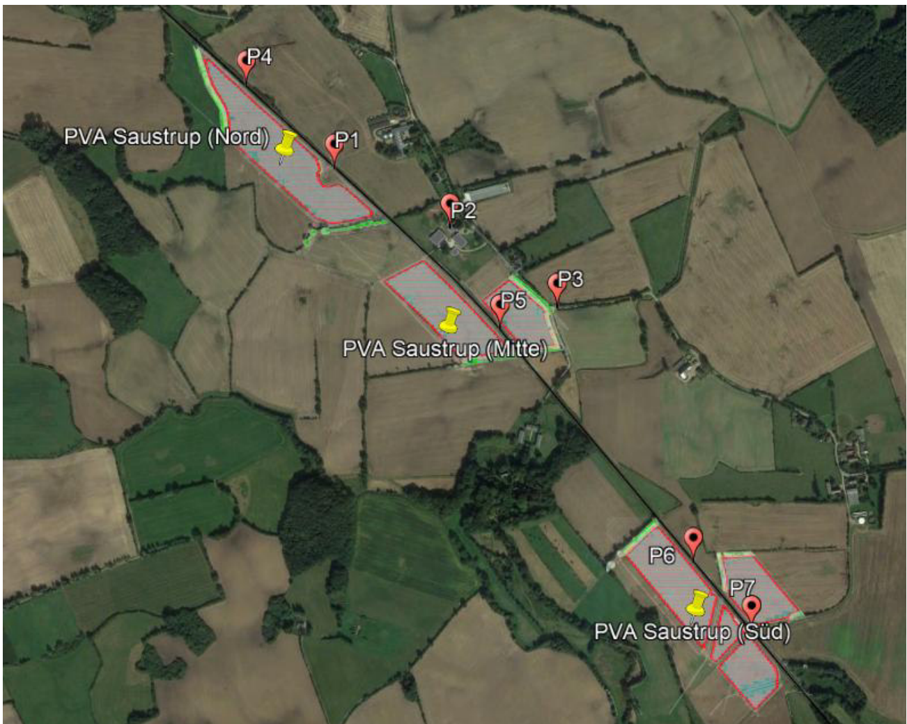
Bild 3.5.1: Übersicht über die PV Anlage und Messpunkte P1-P7 (Quelle: Google Earth/SolPEG)
