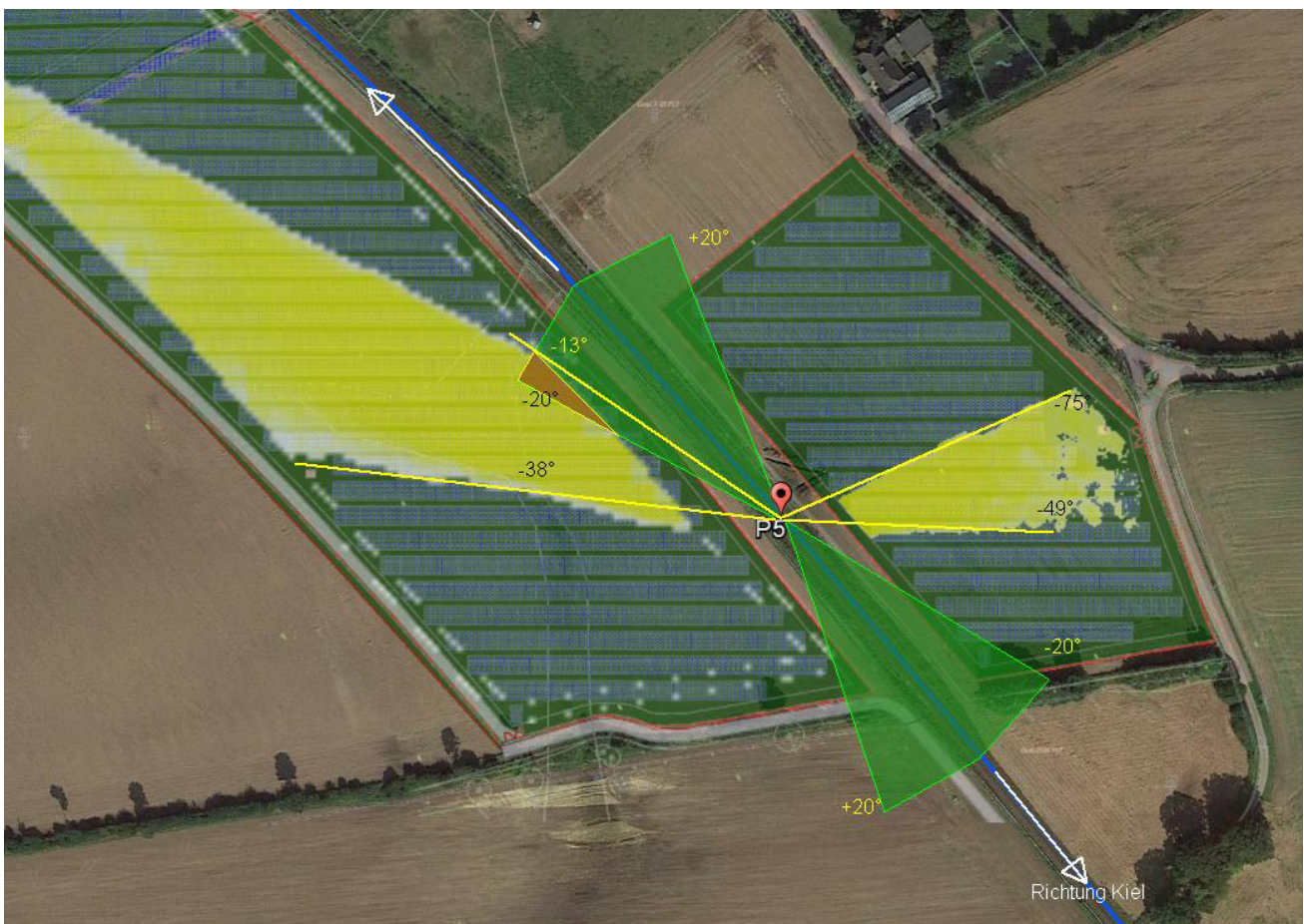
Bild 4.6.1: Simulation am Messpunkt P5 (Quelle: Google Earth / SolPEG)
