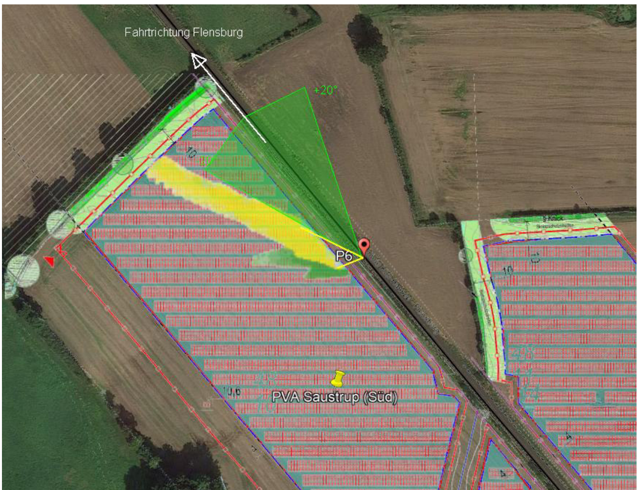
Bild 4.7.1: Ergebnisdetails für Messpunkt P5, PV Feld 5 (Quelle: Google Earth / SolPEG)
